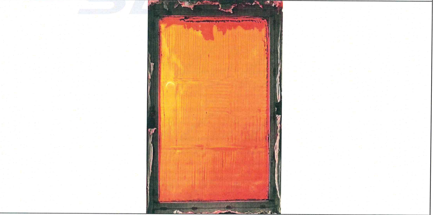
照片二 耐火试验结束时试件情况
